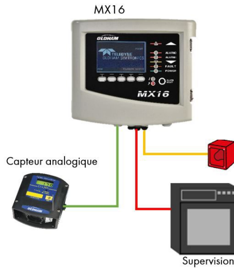
Figur 2: Eksempel på en MX 16-konfiguration med én analog detektor
