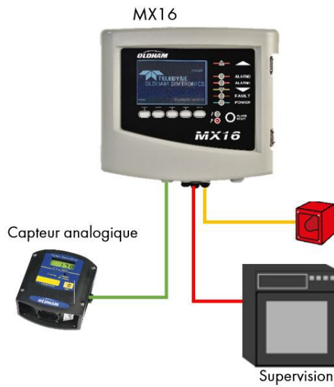
Figure 2 : exemple de configuration d'une MX16 employant un capteur analogique
