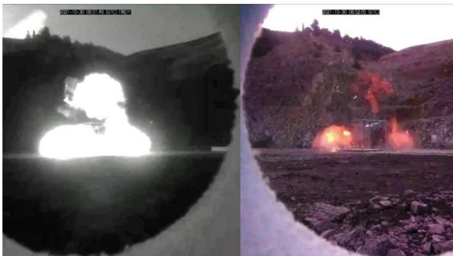
Image de la même explosion d'hydrogène prise à partir d'une vidéo en proche infrarouge et d'une vidéo en couleur
