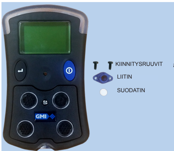
Kuva 4.4 Suodatin ja liitin irrotettu
