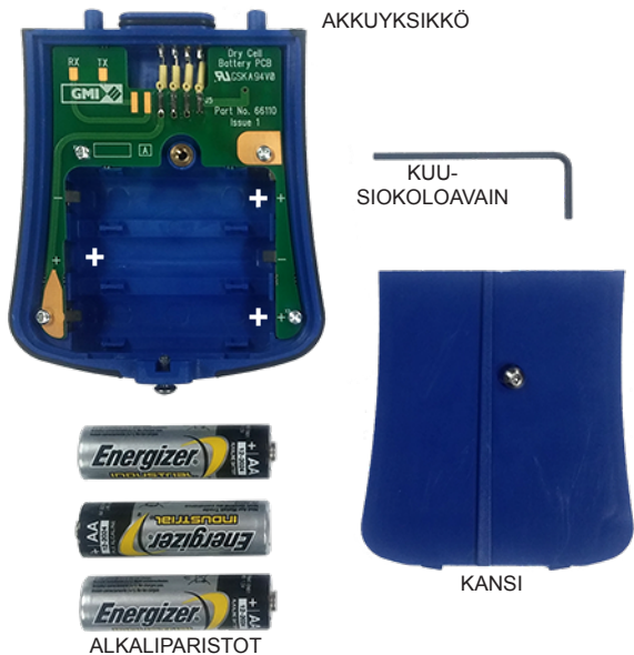
Kuva 4.13 Alkaliparistot poistettu yksiköstä
