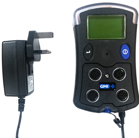
Kuva 4.6 Laitte kiinnitettynä vakiolatauslaitteeseen
