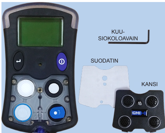
Kuva 4.2 Suodatin ja kansi irrotettu
