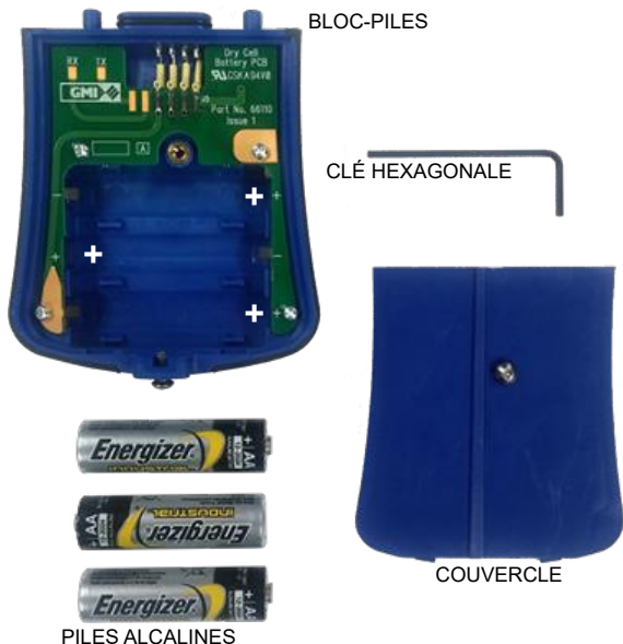
Fig. 4.13 Pile alcalines retirées
