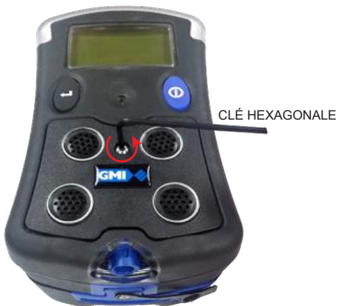
Fig. 4.1 Vis imperdable du couvercle
