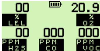
Fig. 2.12 Écran de fonctionnement normal
