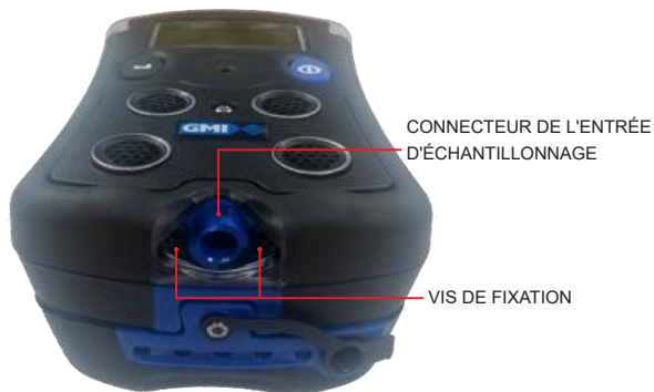
Fig. 4.3 Connecteur de l'entrée d'échantillonnage
