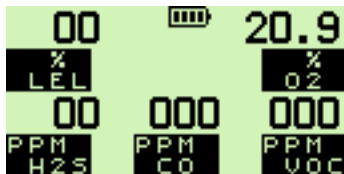
Fig. 2.13 Écran de fonctionnement normal
