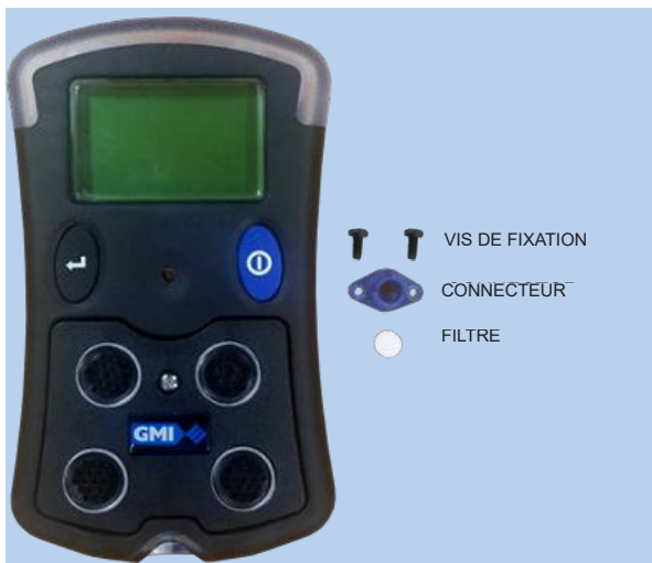
Fig. 4.4 Filtre et connecteur retirés
