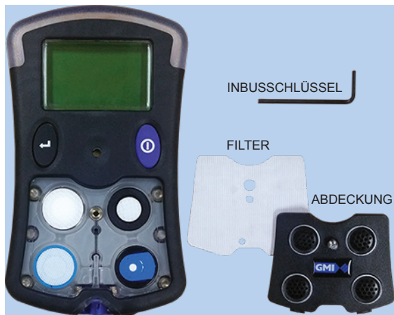
Abb. 4.2 Filter und Abdeckung entfernt
