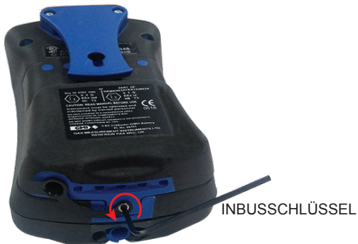
Abb. 4.10 Sicherungsschraube des Batteriepacks
