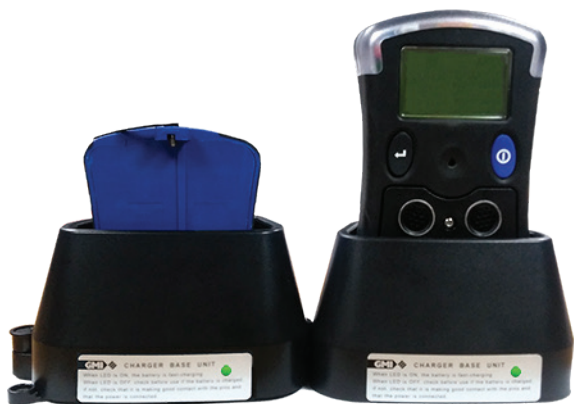
Abb. 4.9 Batteriepack / Gerät an Schnellladegerät / Nebeneinheit(en) angeschlossen
