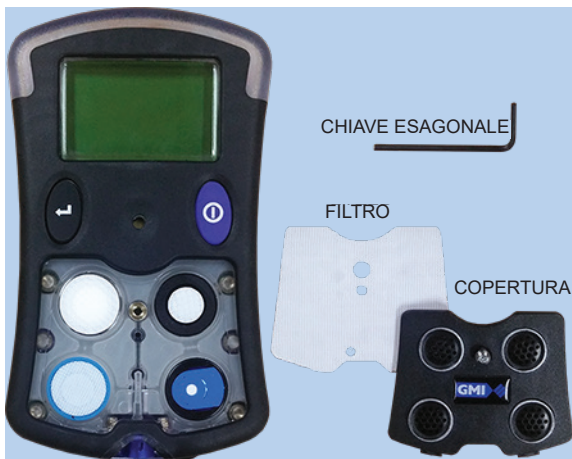
Fig. 4.2 Filtro e copertura rimossi
