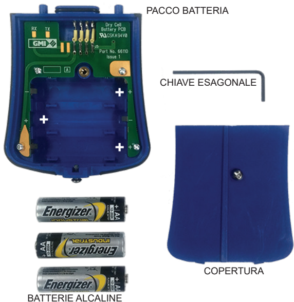
Fig. 4.13 Batterie alcaline rimosse
