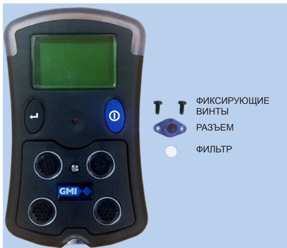
Рис. 4.4 Снятые фильтр и разъем
