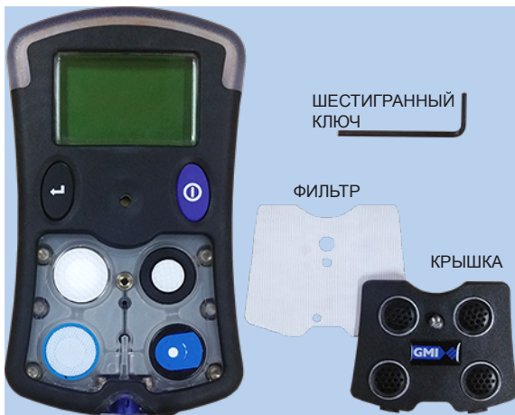
Рис. 4.2 Снятые фильтр и крышка
