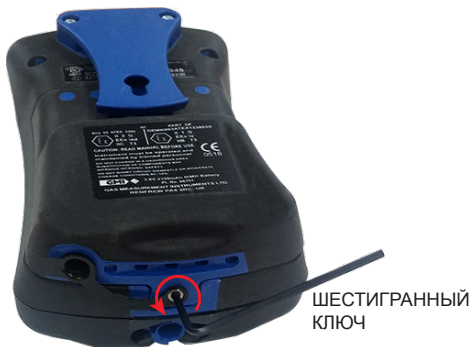
Рис. 4.10 Винт, фиксирующий батарейный блок
