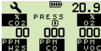
Рис. 3.6 Датчик CO 2 (углекислого газа) — Zero Fault
