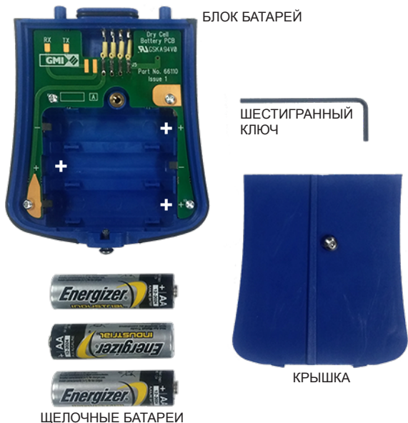
Рис. 4.13 Извлечение щелочных батарей
