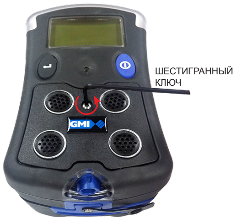
Рис. 4.1 Винт, фиксирующий крышку
