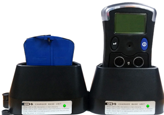
Рис. 4.9 Батарейный блок или прибор, вставленный в устройство для быстрой зарядки (основное или дополнительное)
