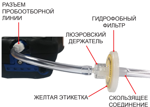
Рис. 4.5 Встроенный гидрофобный фильтр
