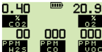
Рис. 3.7 Датчик CO 2 (диоксид углерода) — Zero Fault
