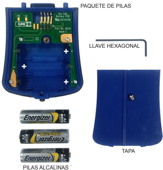
Fig. 4.13 Pilas alcalinas quitadas
