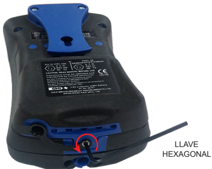
Fig. 4.10 Tornillo prisionero del paquete de pilas
