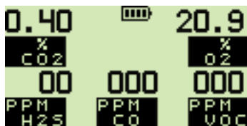
Fig. 3.7 Sensor de CO2 - Zero Fault
