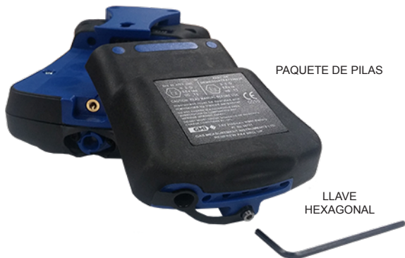
Fig. 4.11 Paquete de pilas quitado
