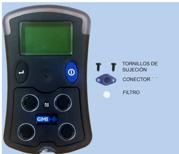
Fig. 4.4 Filtro y conector quitados
