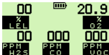
Fig. 1.2 Ejemplo de pantalla (5 gases)
