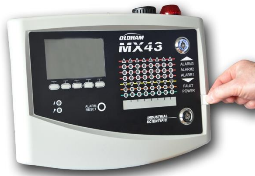
Figur 13: Udtrækning af strimmel.
