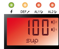
Figure 56 : affichage après détection d'une haute teneur en explosimétrie.
