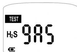
Abbildung 4-2: Manueller Stoßtest – Gas zuführen
