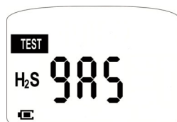
Figura 4-2: Prueba funcional manual - Aplicar gas
