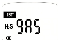
рис. 4-2 Ручной контрольный замер — подача газа
